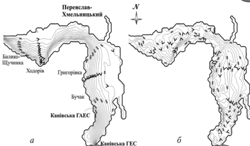
Рис. 2. Циркуляції вод в озерній частині Канівського водосховища: а – при роботі ГАЕС в турбінному режимі та працюючих ГЕС; б – при роботі ГАЕС в насосному режимі та непрацюючих ГЕС. Вітер північний 7 м/с
