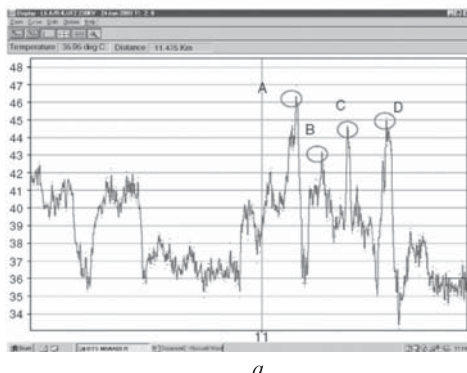
Рис. 6. Температура вдоль высоковольтного кабеля, измеренная волоконно-оптической системой непрерывного температурного контроля (а). А, В, С, D – горячие точки на участке кабельной линии длиной более 11,4 км. Точка А соответствует локальной зоне кабеля, расположенного на глубине 5 м под бетонной дорогой (б) [9].
